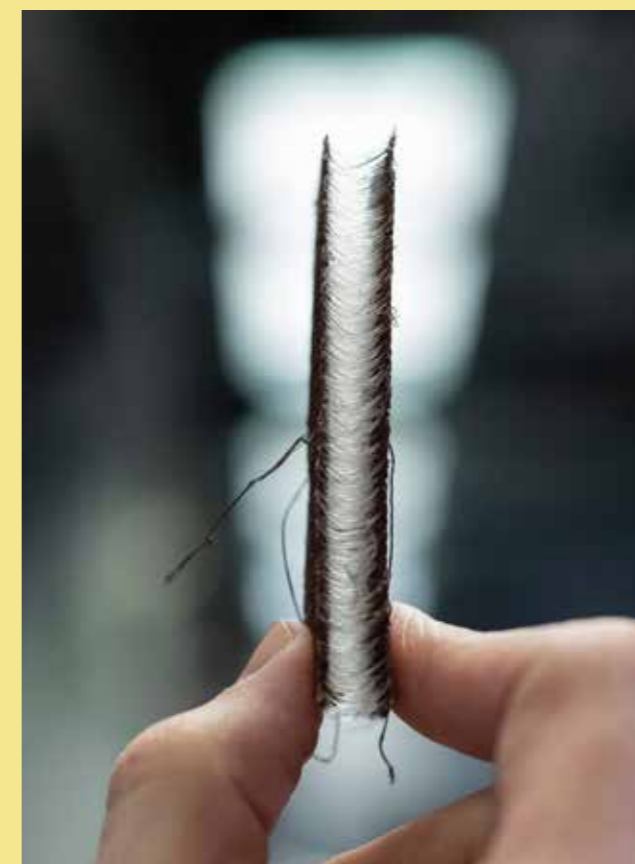
Smartes Gewebe: 3D-Abstandsgewirke aus Polyester, thermoelektrisch beschichtet sowie mit Kupferkontakten versehen, sind die Ausgangsbasis für clevere Kleidungsstücke, die sich für Energiegewinnung und aktive Kühlung eignen. © Sven Döring
