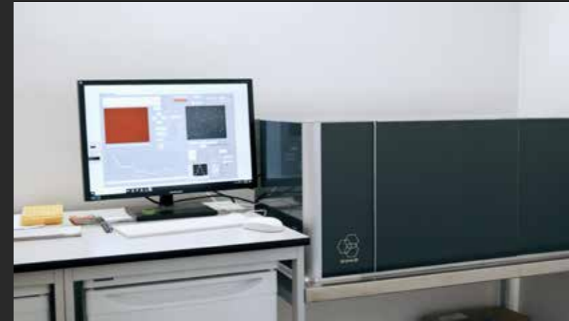
Der Immunantwort auf der Spur: High-Throughput Screening Raman Spectroscopy (HTS-RS) © Leibniz-IPHT
