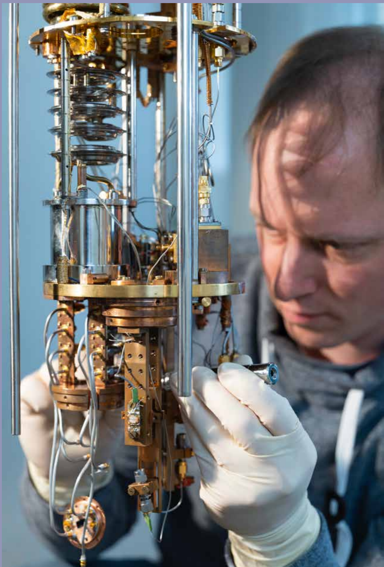
Dr. Gregor Oelsner, Leiter der Arbeitsgruppe Quantenschaltungen in der Forschungsabteilung Quantensysteme sowie Teilprojektleiter von QSolid am Leibniz-IPHT, bereitet den Kryostaten für ultratiefe Temperaturen zur Forschung an neuen supraleitenden Schaltungen für den Quantencomputer der Zukunft vor.
