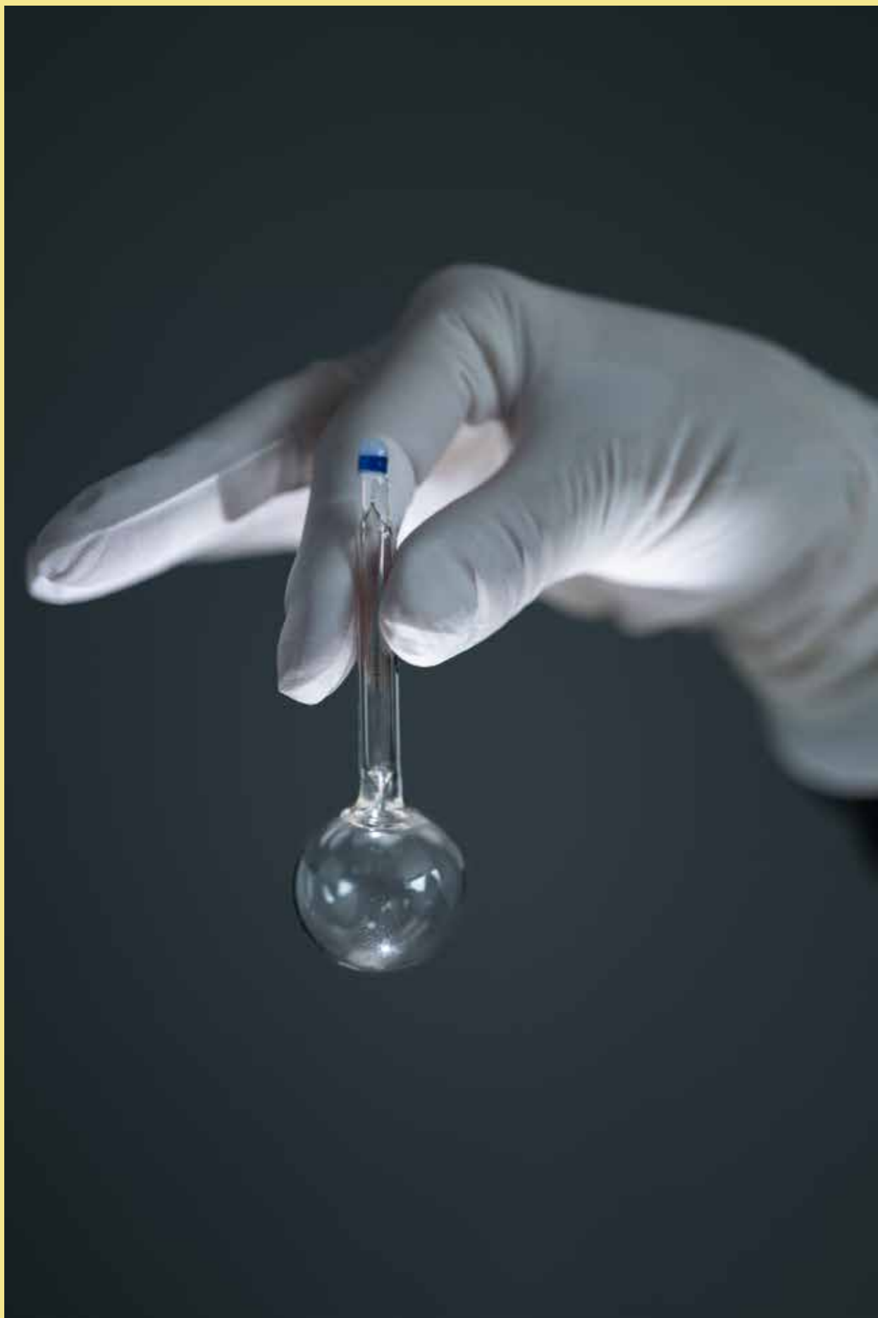
Die Atome befinden sich in einer speziellen gläsernen Dampfzelle, die in einem magnetisch sehr gut abgeschirmten Aufbau Signalen der exotischen Materie nachspüren.
